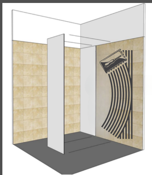
Fig. 2 - Applicazione colla tramite spatola dentata a tutta parete
